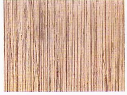
3. ผิวที่ขัดแล้วจะละเอียดและเรียบขึ้น ความละเอียดของผิวที่จะให้มากหรือให้น้อยนั้น ขึ้นอยู่กับวัตถุประสงค์ที่จะนำไปใช้ในงานได้ The polished surface will be finer and smoother. The level of fineness depends on customers' requirement and application
